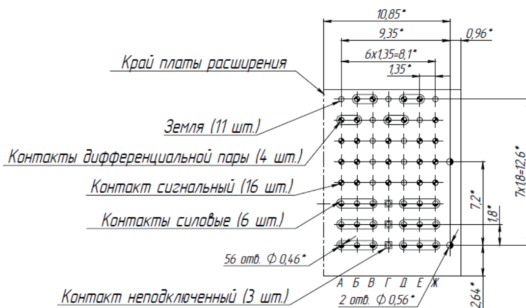
Разметка печатной платы для монтажа модуля 445-МВО
